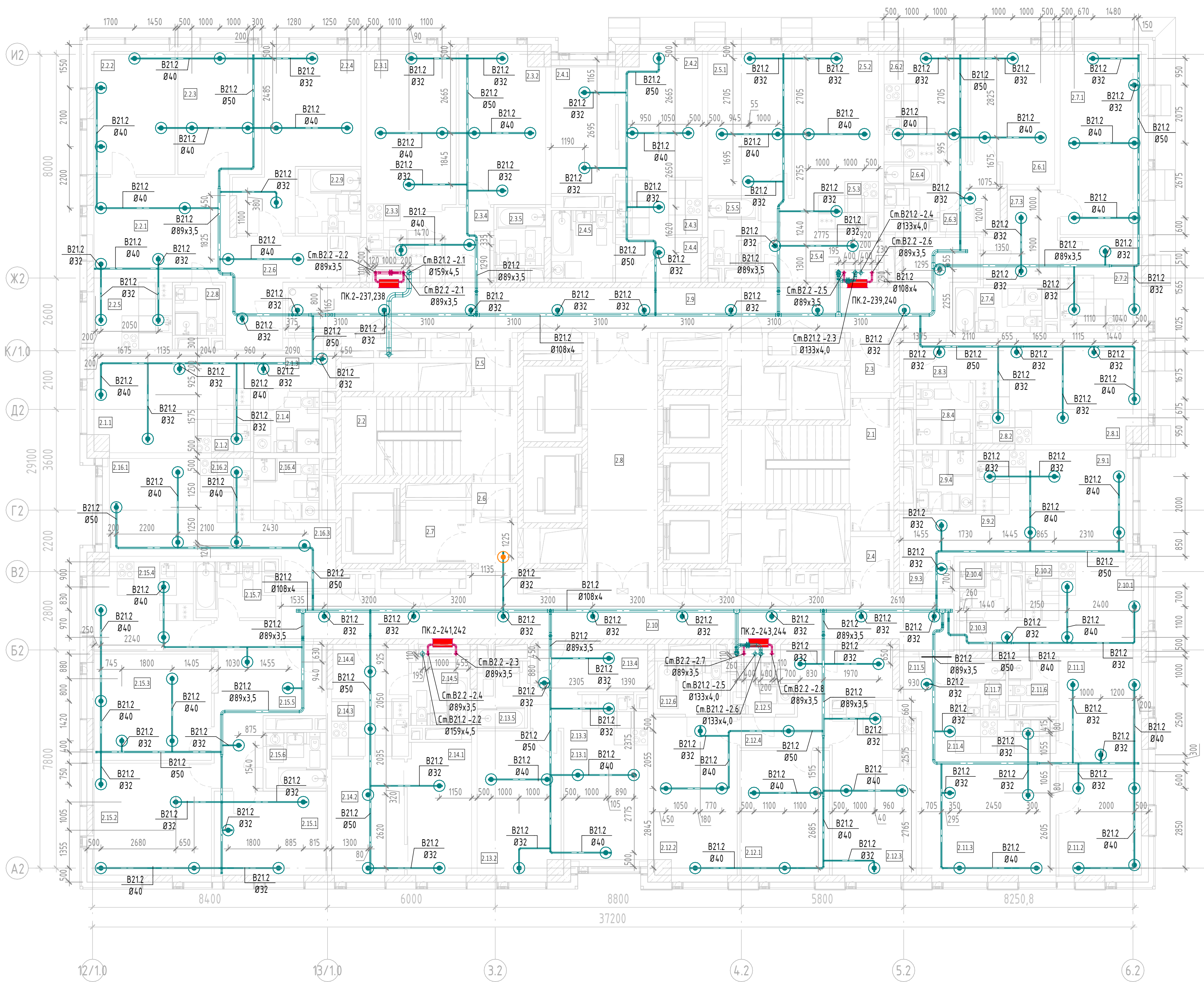
План систем АУПТ и ВПВ 32 этаж (отм. +103,500).
